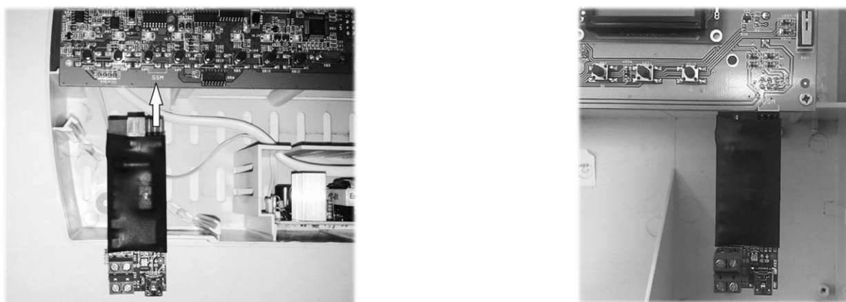
Рис. 4. Подключение адаптера ПК к прибору (слева в приборе до 8 ШС, справа в приборе до 24 ШС)
