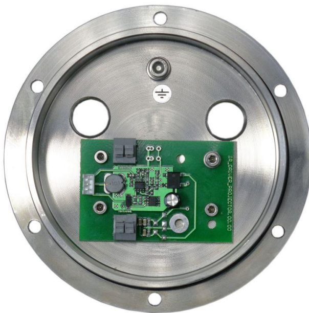
Рисунок 5 – Плата коммутации ИК-прожектора
