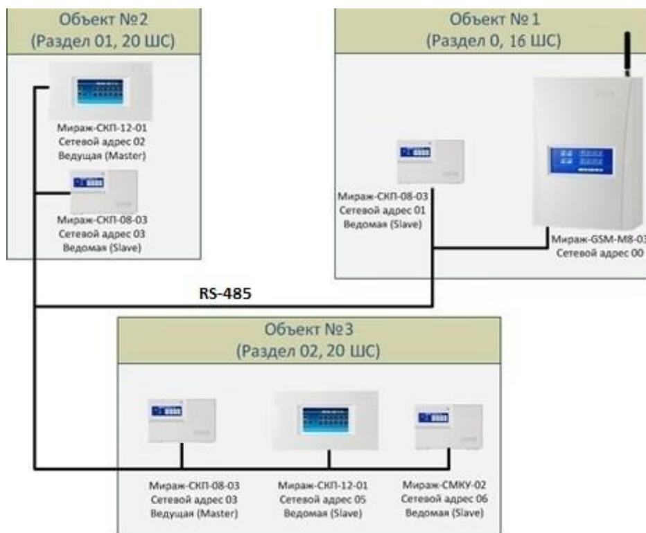
Рис. 4.1. Пример топологии сети RS-485 объектового оборудования Мираж
