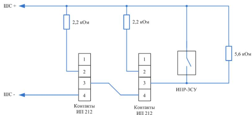
Рис. 8.1. Подключение ручного пожарного извещателя и дымовых пожарных извещателей для стратегий реагирования *Дымовой без перезапроса* и *Дымовой с перезапросом*
