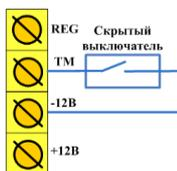
Рис. 8.5. Схема подключения скрытого выключателя
