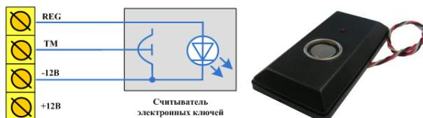
Рис. 8.3. Схема подключения считывателя Touch Memory
