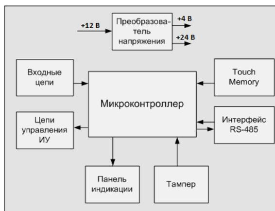
Рис. 3.1. Функциональная схема
