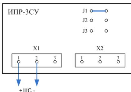
Рис. 8.2. Подключение извещателя *ИПР-ЗСУ* с имитацией дымового извещателя
