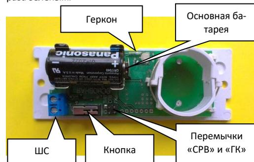
Двойным нажатием на кнопку извещателя инициируйте передачу посылки на прибор. Прибор, получив эту посылку, обрабатывает её и выдает результат:
