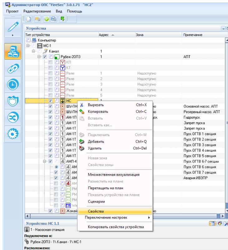
Рис. 5 Насосная станция в дереве устройств
