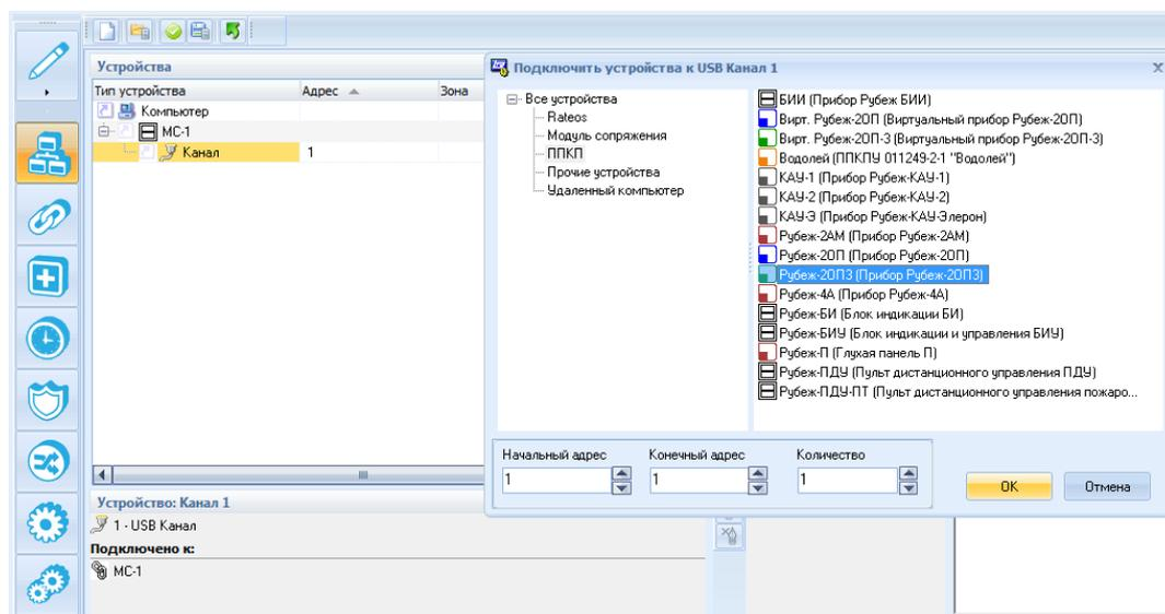
Рис. 1 Подключение прибора Рубеж-2ОП3 к Компьютеру
