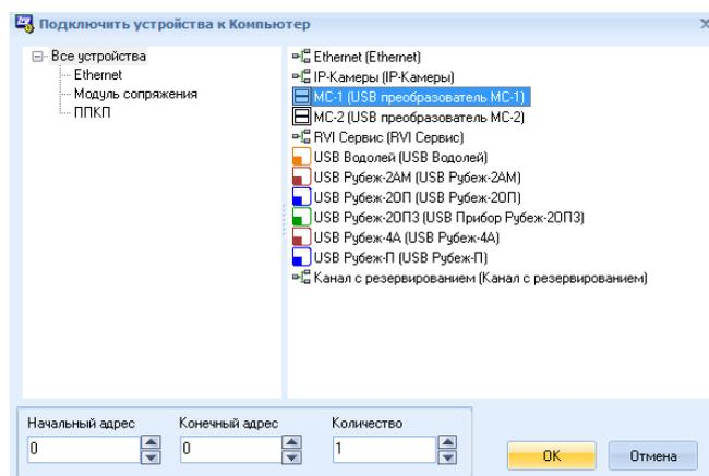
Рис. 8 Подключение в Компьютеру модуля сопряжения MC-1
