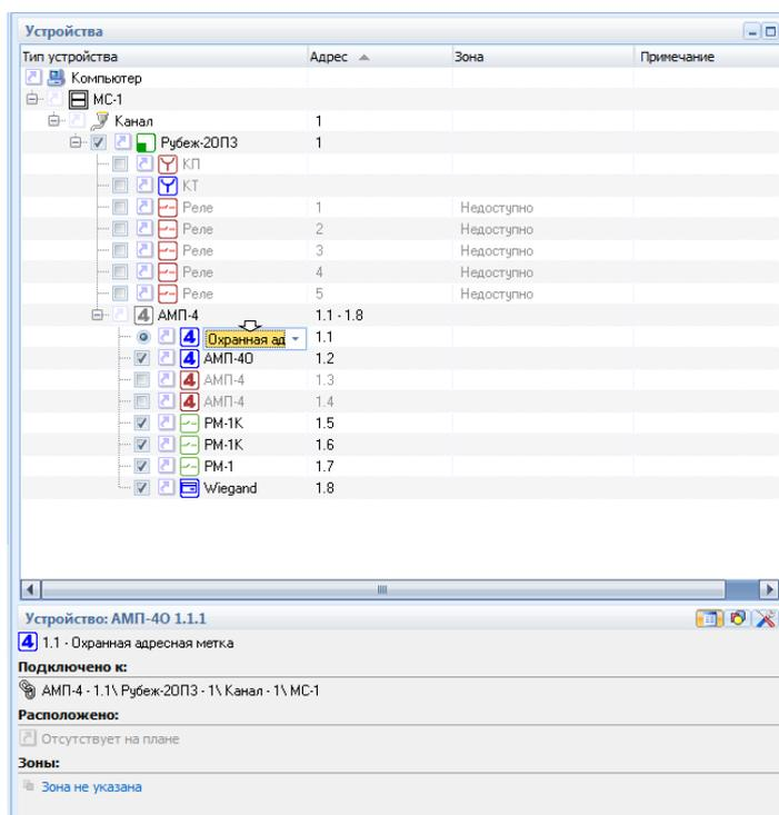
Рис. 12 Адресная охранный метка АМП-4 в дереве устройств
