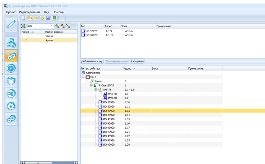
Рис. 17 Добавление охранных устройств в зону Архив
