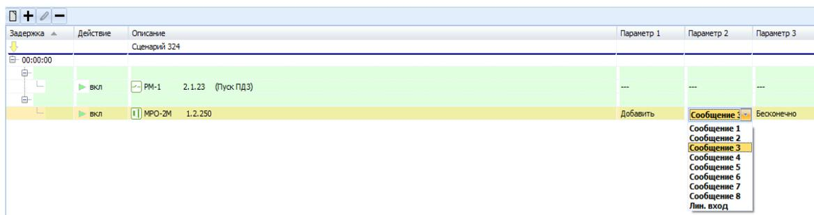
Рис. 20 Окно вкладки **Сценарии**, исполнительный блок включает модуль речевого оповещения с сообщением 3
