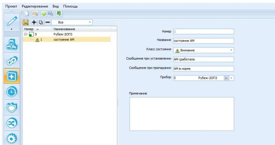
Рис. 5 Вкладка **Виртуальные состояния**, добавили виртуальное состояние 1 (Состояние АМ)
