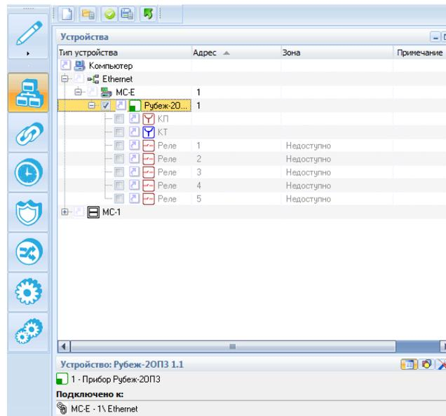
Рис. 9 Подключение Рубеж-20ПЗ к компьютеру по Ethernet
