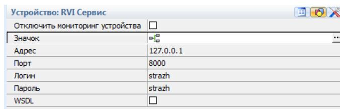
Рис. 46 Окно свойств устройства RVI сервис
