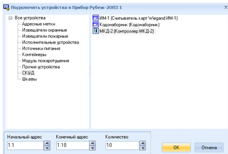
Рис. 2 Подключение МКД-2 к Рубеж-20ПЗ
