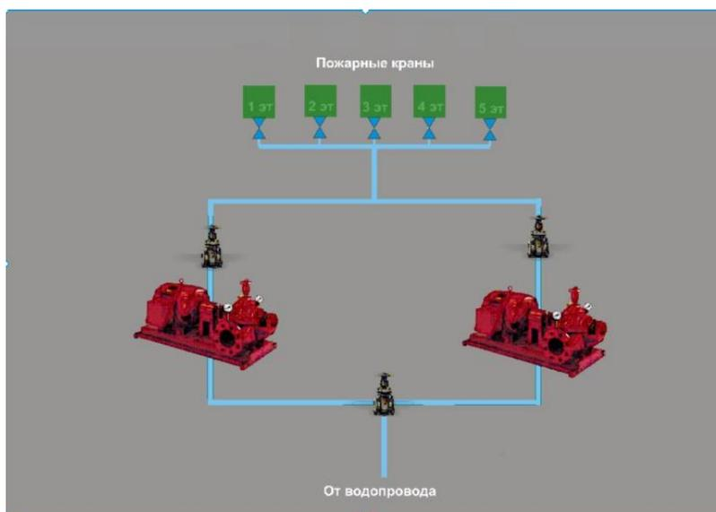
Рис. 27 Система внутреннего пожаротушения
