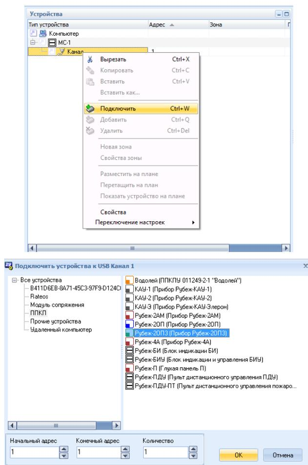
Рис. 9 Подключение приемно-контрольного прибора к MC-1
