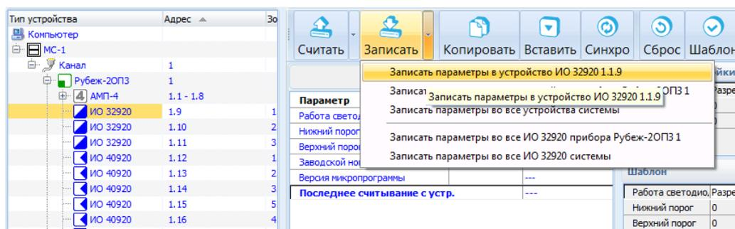
Рис. 3 Вкладка Конфигуратор, запись параметров в устройство ИО 32920
