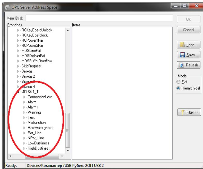
Рис. 8 Состояния устройства ИП-64 в формате OPC
