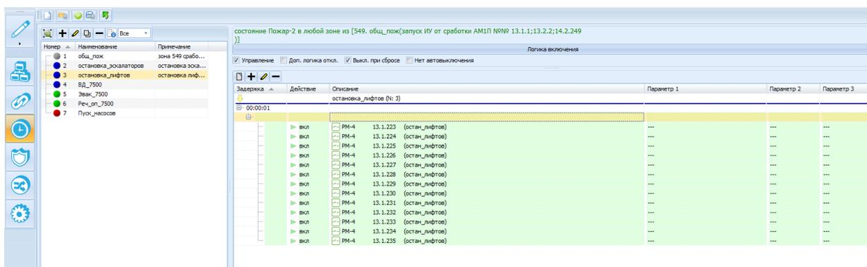
Рис. 17 Окно вкладки **Сценарии**, исполнительный блок в сценарии *Остановка лифтов (№3)*, задержка блока 1 сек.
