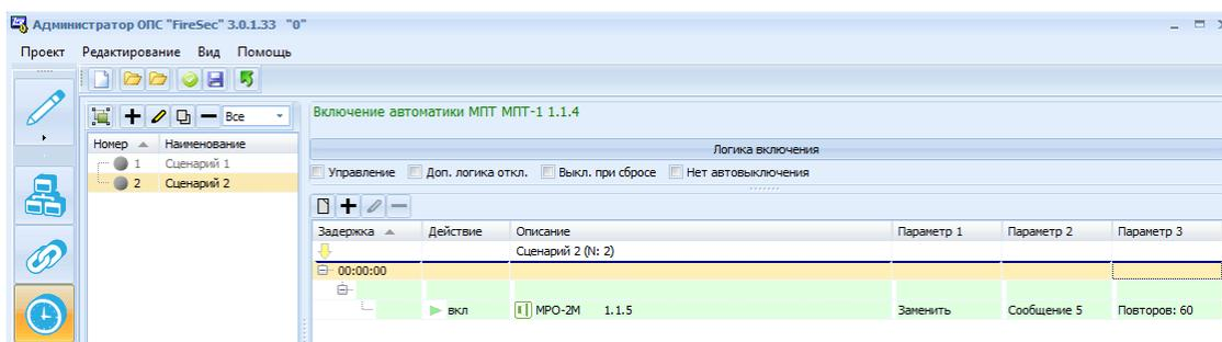
Рис 21. Окно вкладки **Сценарии**, при включении автоматики МПТ изменяется сообщение модуля речевого оповещения
