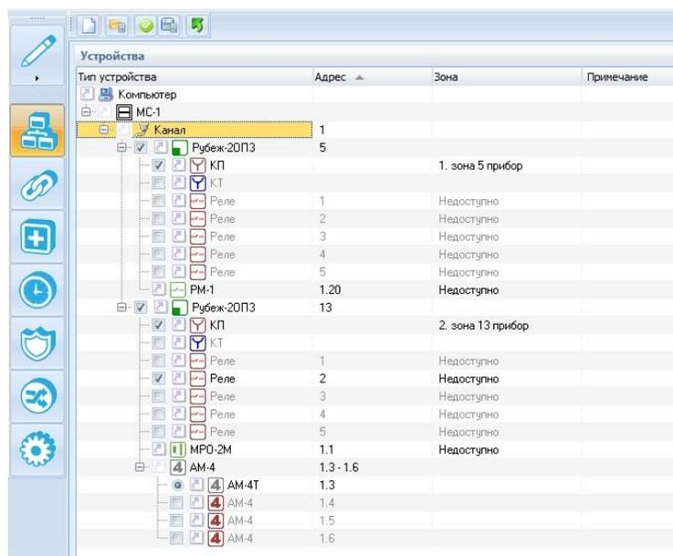
Рис. 3 В дерево устройств подключены два прибора Рубеж-20ПЗ
