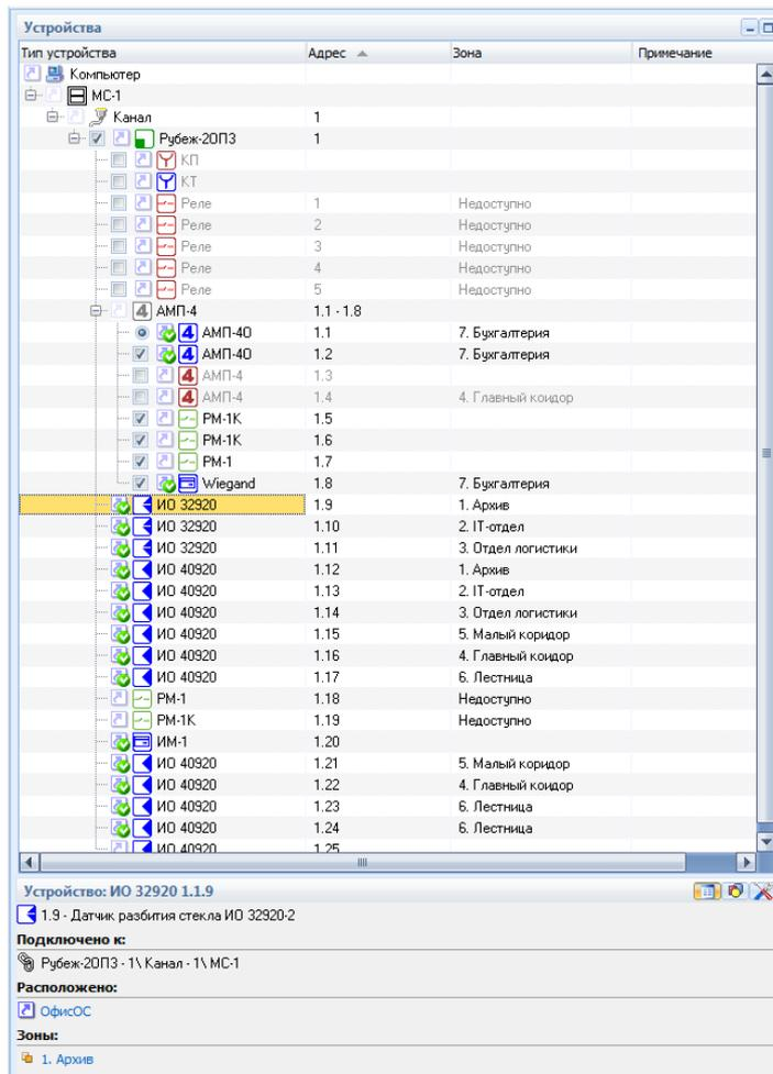
Рис. 42 Дерево устройств системы, устройства привязаны к зонам
