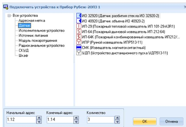
Рис. 13 Подключение к Рубеж-20ПЗ трех датчиков ИО 32920-2
