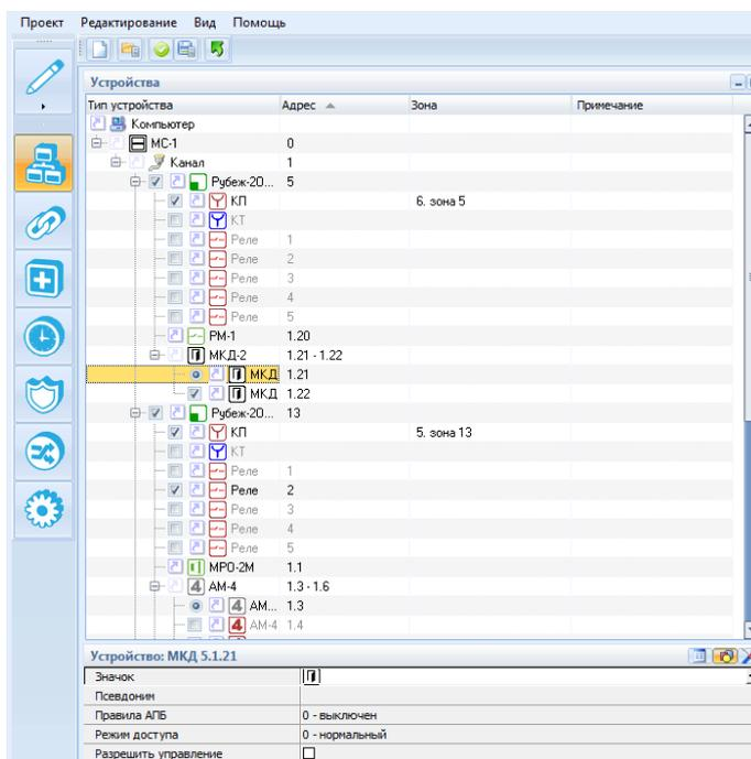
Рис. 1 Модуль контроля доступа МКД-2 в дереве устройств
