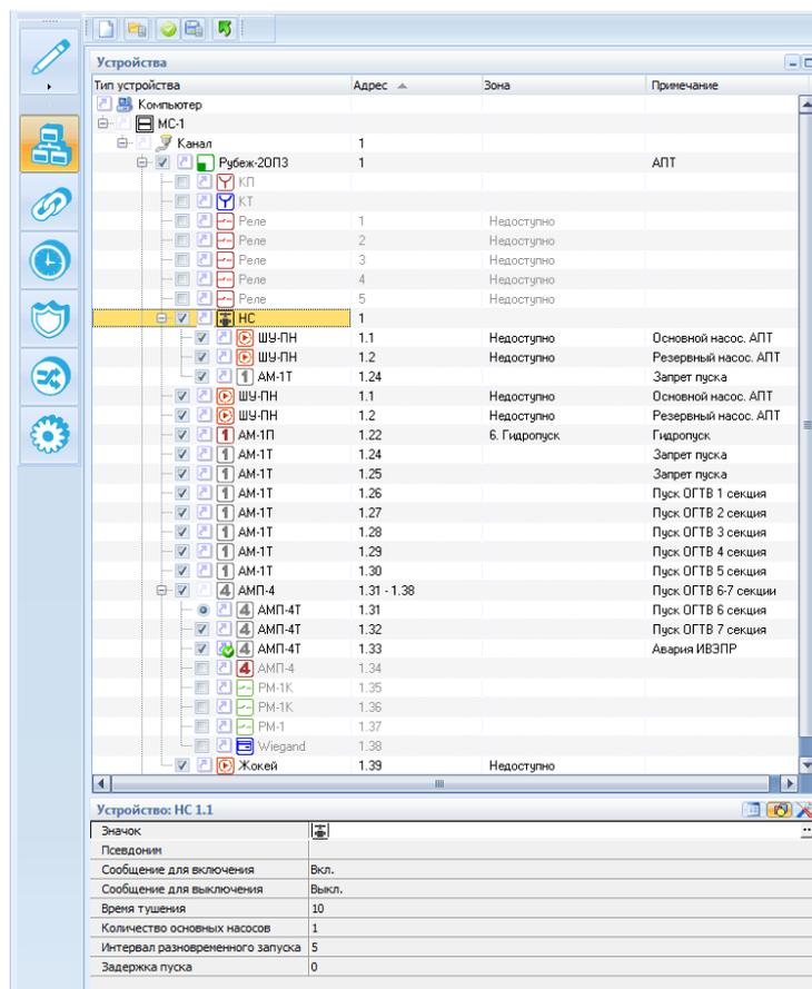
Рис. 7 Список подключенных устройств
