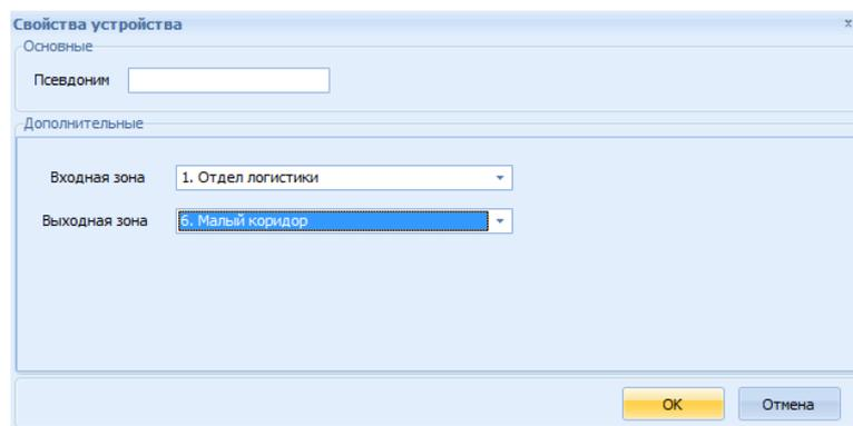
Рис. 2 Задание входной и выходной зон модуля контроля доступа
