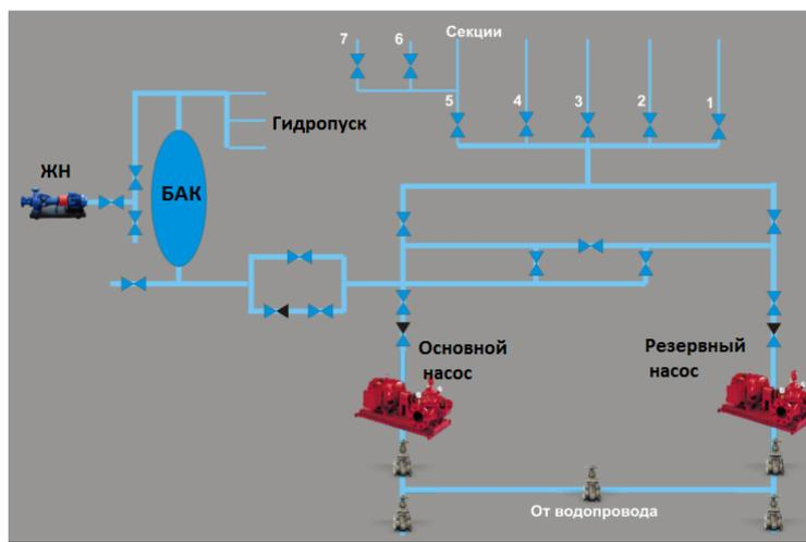
Рис. 1 Графическая схема насосной станции, используемой на объекте
