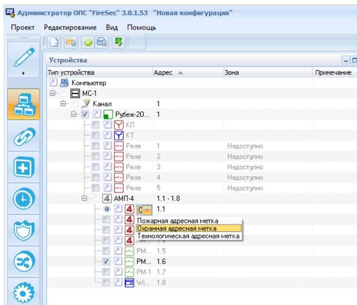
Рис. 1 Подключение охранной адресной метки к Рубеж-2ОПЗ
