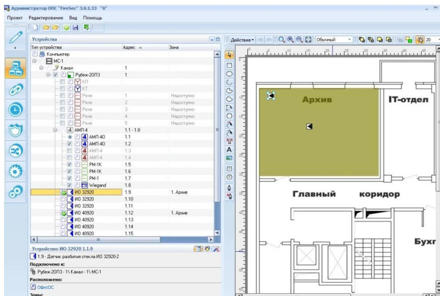
Рис. 40 Расположение устройств в зоне *Архив*
