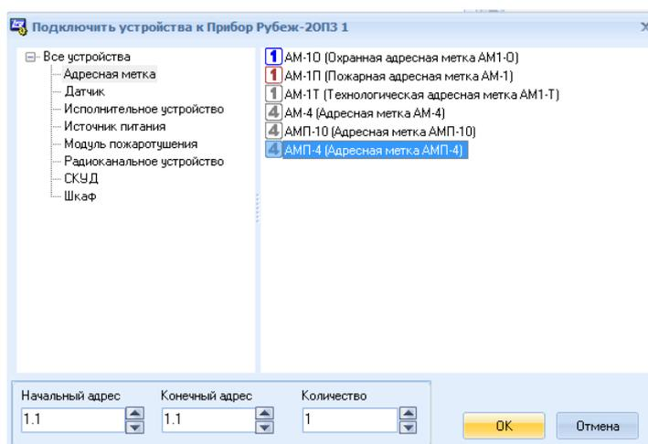
Рис. 11 Подключение к Рубеж-2ОПЗ адресной метки АМП-4
