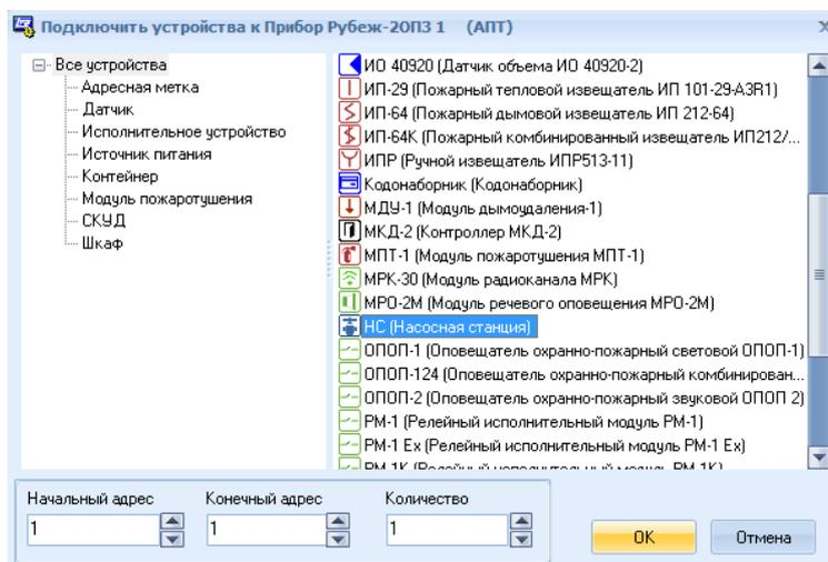
Рис. 4 Подключение к Рубеж-20ПЗ Насосной станции
