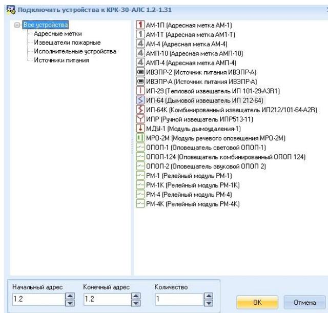
Рис. 27 Подключение адресных устройств к КРК-4БС
