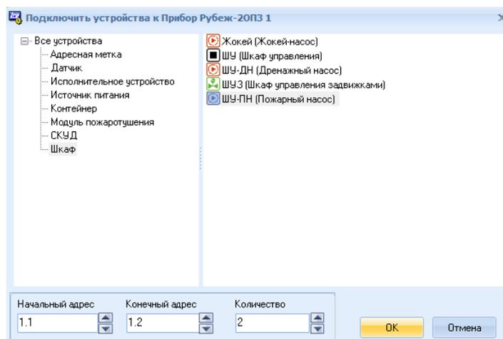
Рис. 2 Подключение шкафов управления ШУ-ПН в дереве устройств
