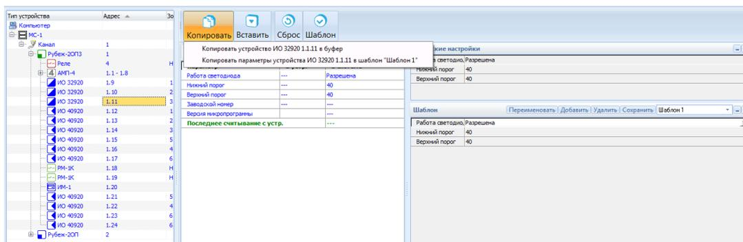
Рис. 3 Вкладка **Конфигуратор**, работа с полем параметров (кнопка Копировать)
