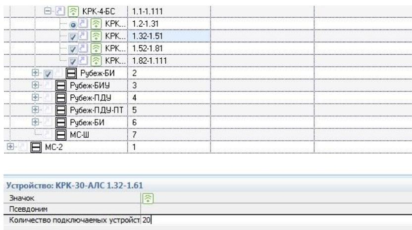
Рис. 26 У второго ведомого конвертора количество подключаемых устройств изменено на 20
