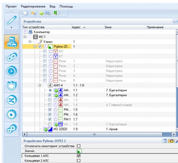
Рис. 5 Выбор топологии АЛС прибора Рубеж-2ОПЗ
