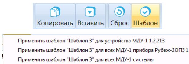
Рис. 6 Вкладка **Конфигуратор**, работа с полем параметров (кнопка **Шаблон**)
