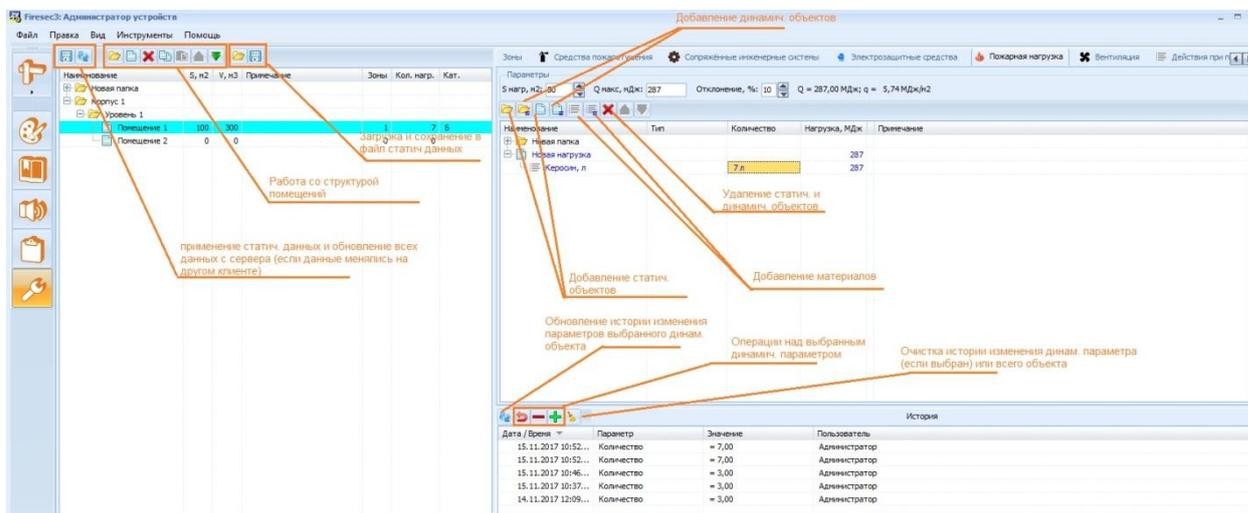
Рис. 2 Окно вкладки **Инвентаризация**, функции панели инструментов
