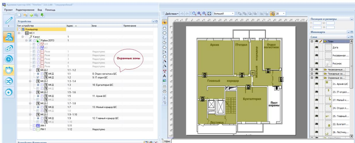
Рис. 14 Вкладка Планы, план Офиса с размещенными устройствами
