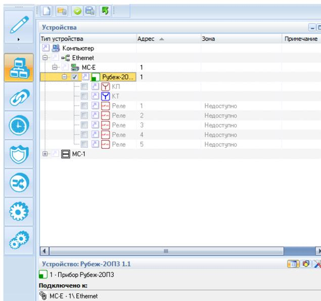
Рис. 29 Подключение Рубеж-20ПЗ к компьютеру через MC-E
