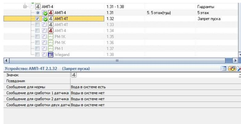
Рис. 29 Свойства адресной метки АМП-4Т
