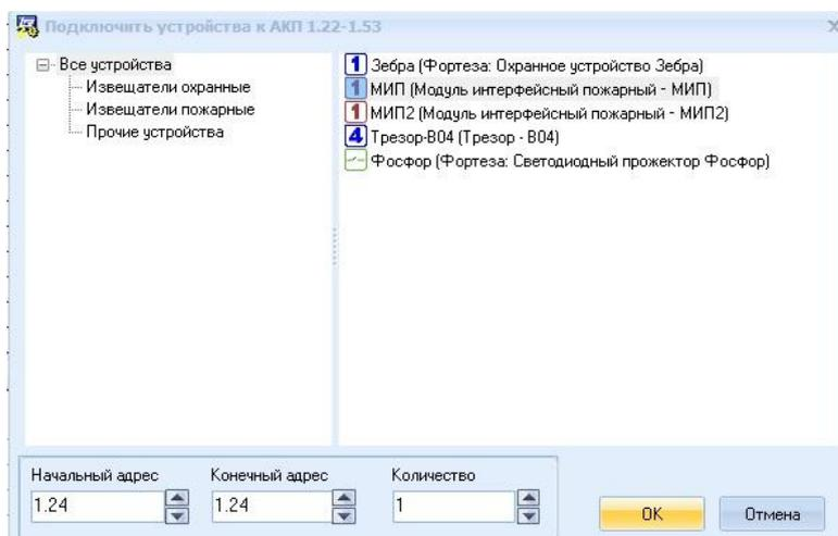
Рис. 17 Подключение сторонних устройств к АКП
