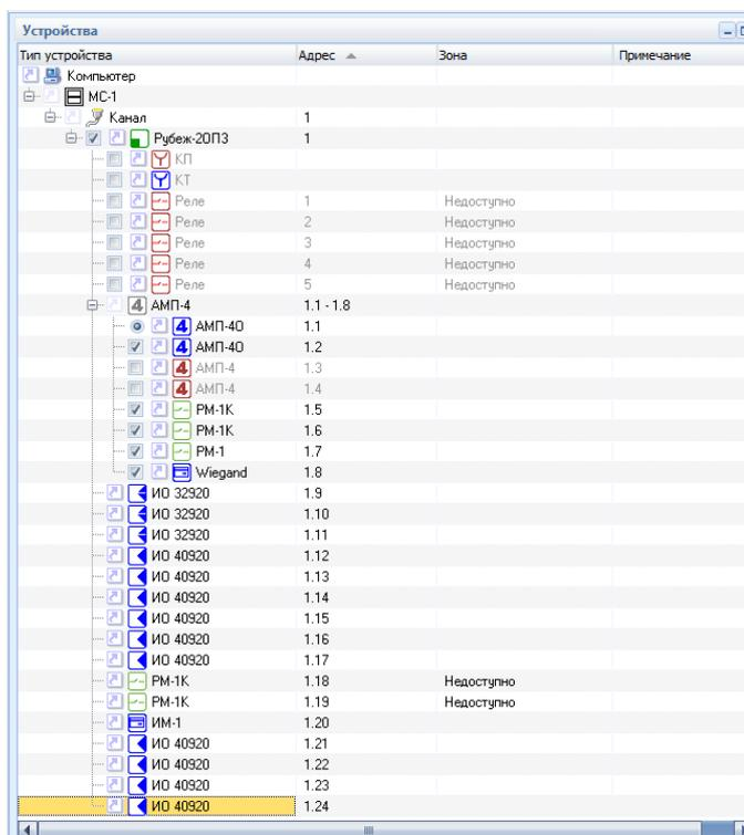
Рис. 14 Дерево устройств с подключенными охранными устройствами
