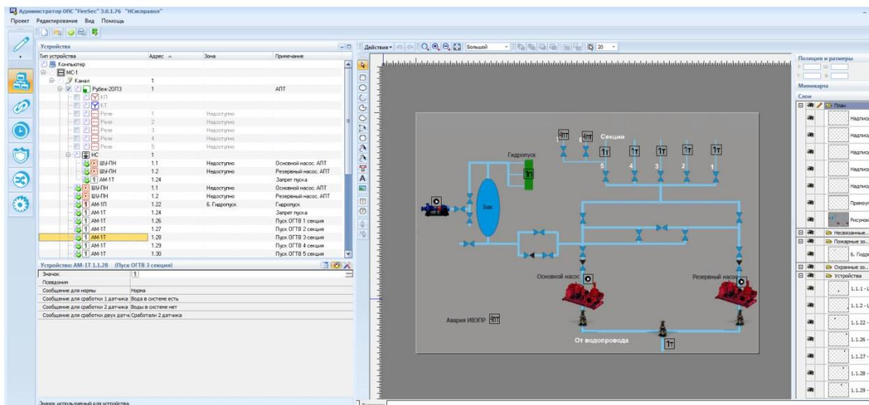
Рис. 21 План системы пожаротушения с использованием насосной станции
