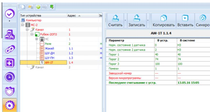
Рис. 2 Вкладка Конфигуратор, параметры считанные с устройства AM-1T
