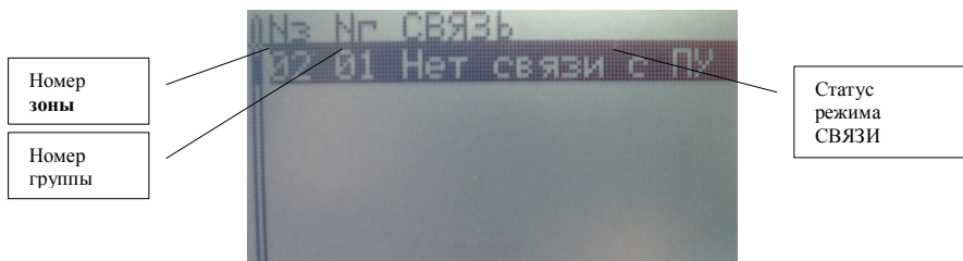
Рис.11 Меню СВЯЗЬ, вызывается кнопками «F2»-«7» (расшифровка направлений поступления сигнала потери связи).
