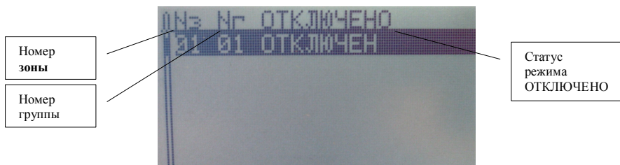
Рис.12 Меню ОТКЛЮЧЕНО, вызывается кнопками «F2»-«8» (расшифровки направлений поступления сигнала ОТКЛЮЧЕНО).
