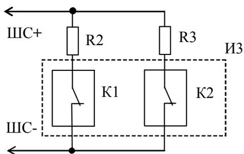
И3 - нормально-замкнутый извещатель с контактом блокировки корпуса (тампер);
