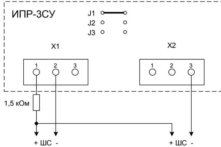
Имитация теплового датчика
