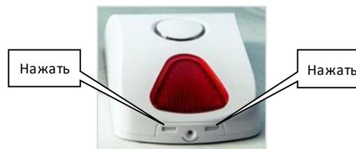
Для включения питания оповещателя удалите (вытяните) бумажную ленту, изолирующую контакт основной батареи оповещателя. Резервная батарея установлена и готова к работе.
